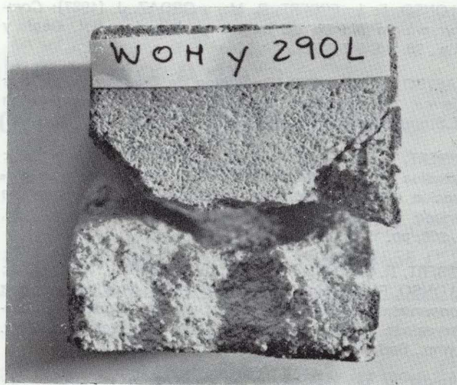
Figura 13.—Probeta tratada con WOH y 290 L, después de los ciclos de cristalización de sales. Debido a la presencia de éstas, se produce una separación (fragmentación) de la piedra entre la parte impregnada y el resto no impregnado.
