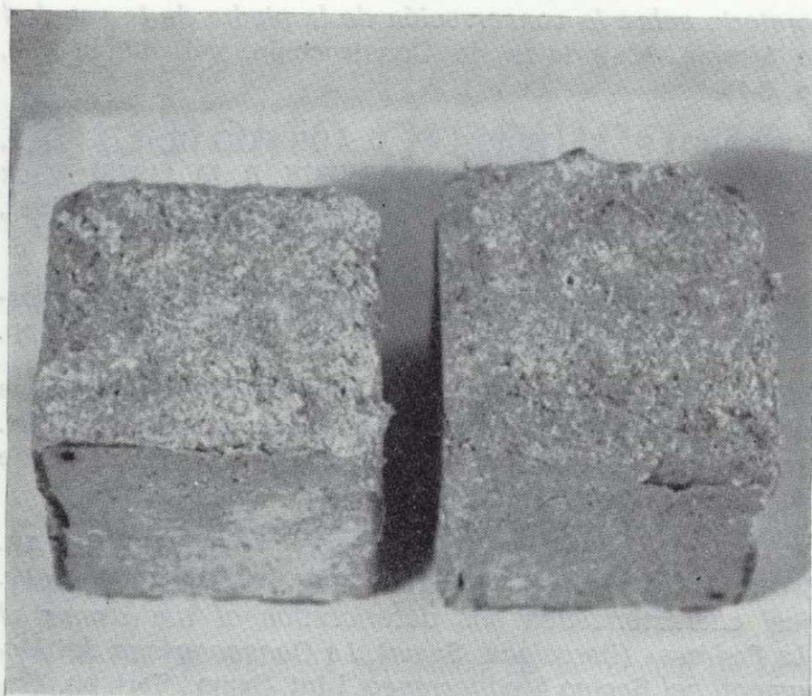
Figura 11.—Probetas después de los ciclos de cristalización de sales, en las que se aprecia una de las caras sin tratar (parte superior) y otra tratada (frontal) con PB 72+DF 104. Resalta la separación de esta última del resto del material.
